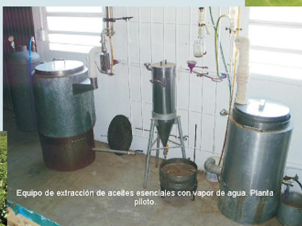
Equipo de extracción de aceites esenciales con vapor de agua. Planta piloto.
